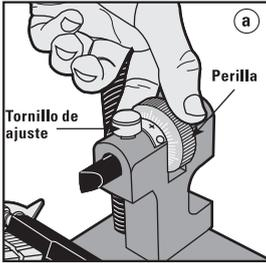
(a) Cuando ajuste la guía, primero afloje ligeramente el tornillo de ajuste, después gire la perilla hasta realizar el ajuste requerido y apriete el tornillo.
